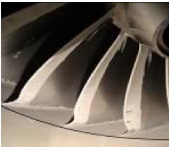
*Como ejemplo de máquinas que pueden ser afectadas por la ceniza podemos citar turbinas de gas (en plantas generadoras de energía eléctrica, en el transporte de gas por gasoductos o plantas industriales) o incluso turbinas de centrales hidroeléctricas, como las turbinas tipo francis de la central hidráulica de San Francisco (Ecuador), que aceleró su erosión por la alta presencia de sólidos en el Río Pastaza.*
